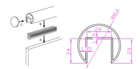
FIGURE 3—TOP RAIL CONNECTION
