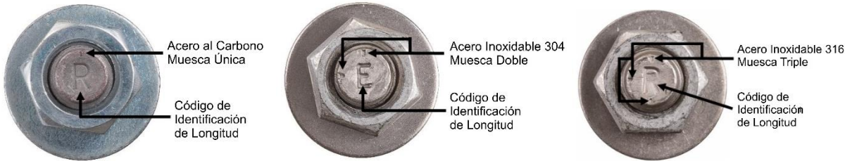
FIGURA 5—CABEZA DEL ANCLAJE CON CÓDIGO DE IDENTIFICACIÓN DE LONGITUD Y CABEZA KB-TZ2 CON MUESCAS GRABADAS EN RELIEVE
