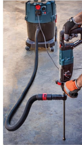
Broca Bosch/Simpson Strong-Tie DXS usada con el sistema de aspiración de polvo descrito en la sección 3.2.3.2.
